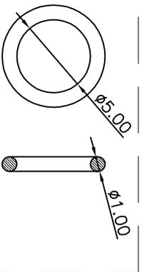
注: 防水圈是圆形截面, 直径为1.0mm的硅胶圈, 防水圈挤压力, 由1.0mm挤压到0.5mm ~ 0.6mm, 防水效果好
